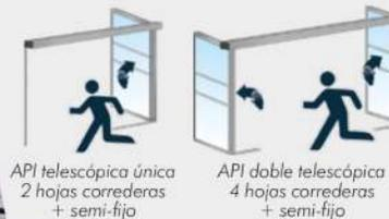
Disponible en versión simple o doble, las hojas pivotan manualmente para permitir la evacuación de emergencia o el paso de objetos voluminosos.
